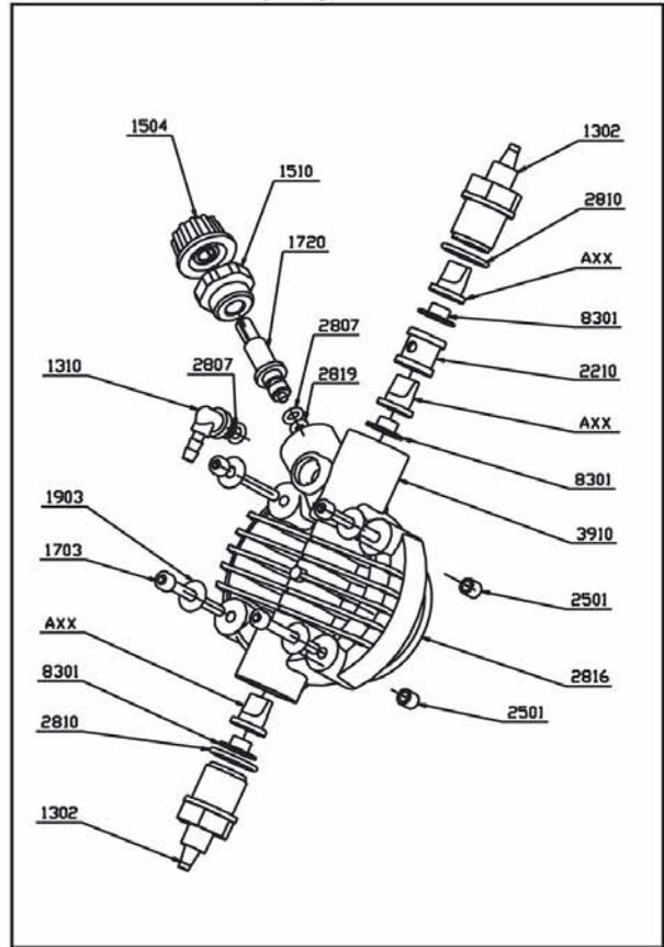
**Elettromagnete Completo - Complete Electromagnet**
