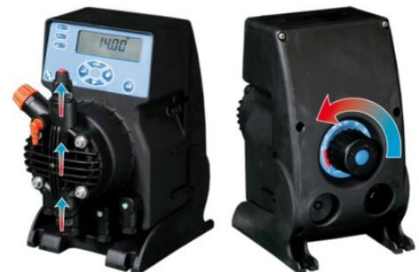
**Пример:** Для того чтобы дозировать 1 л/ч насосом 2 л/ч–10 бар, при максимальной частоте импульсов (120 в минуту), необходимо установить ручку регулировки длины хода плунжера в среднее положение, что будет соответствовать приблизительно 50% требуемого объема впрыска.
